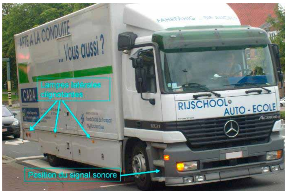
FIGURE 5 : Positionnement du système Lisa-2-Alert sur le camion test
